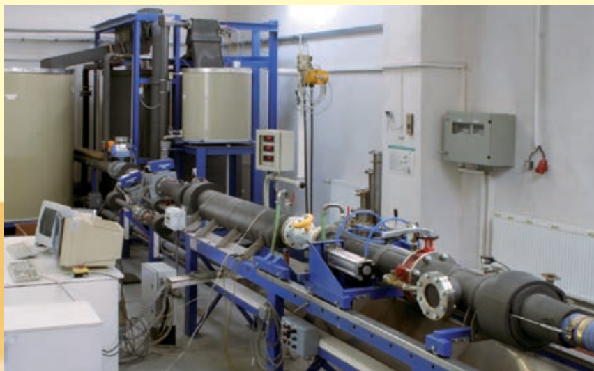
ZKUŠEBNÍ STAND PRŮTOKOMĚRŮ DIMENZÍ DN25 ÷ DN200
